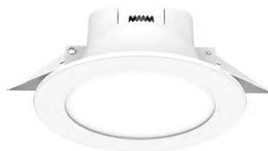
IP40 / IP54 façade IK06 DIM TRIAC 90° Ø68 - 74 mm ISOLANT ROULEAU IRC>80 Classe II 35 000 h (L70)
